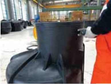
İşaretili boyun kısmı ile çok kolay kot ayarı yapılabilir.
